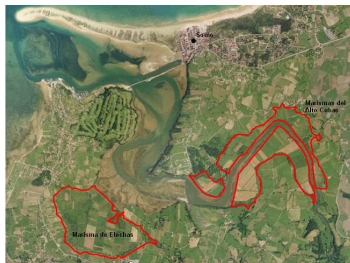
Figura C.88. Rellenos de la ría de Cubas que alteran la morfología del sistema estuarino.
